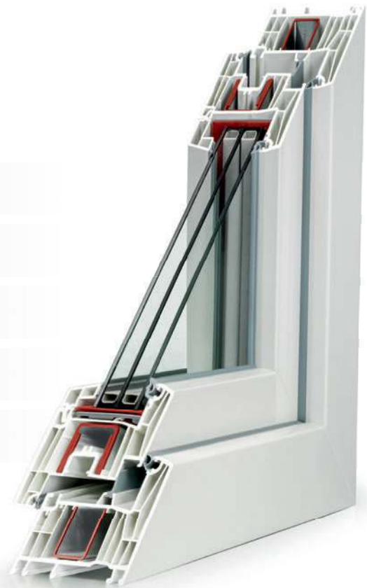
Przykład okna Warmic ze standardowym zestawem trzyszybowym: 4/16/4/14/4.
