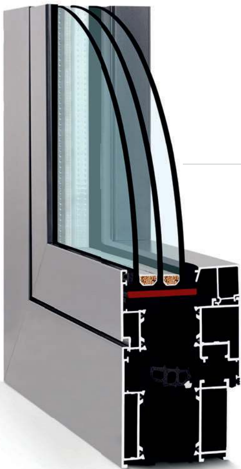
Przekrój okna Solid ze standardowym zestawem szybowym 4/16/4/16/4
