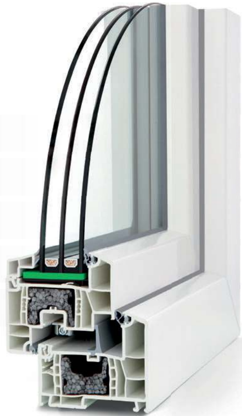
Przykład okna Hotic ze standardowym zestawem trzyszybowym: 4/12/4/12/4, wypełnienie termiczne - opcja.
