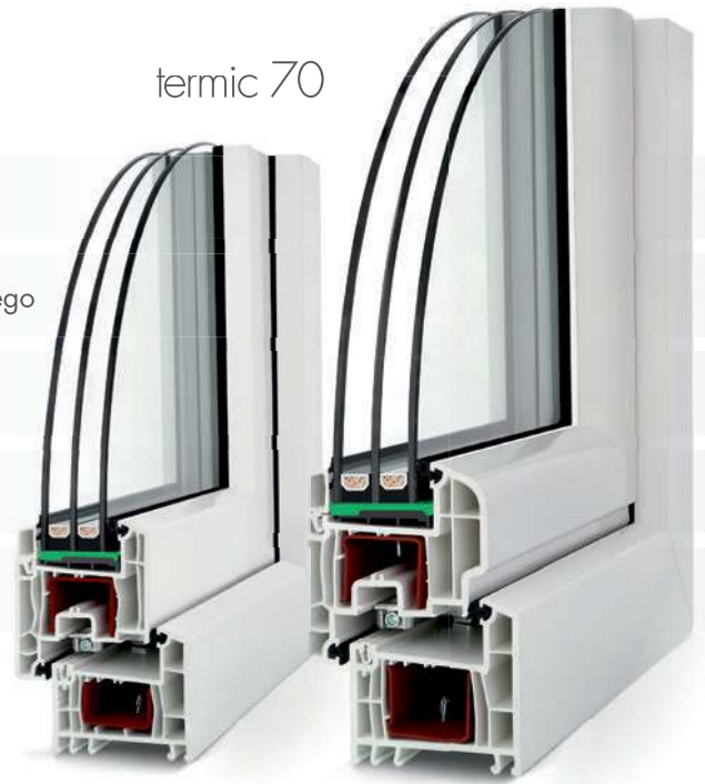
Przykład okna Termic i Termic 70 z zestawem trzyszybowym: 4/12/4/12/4.
